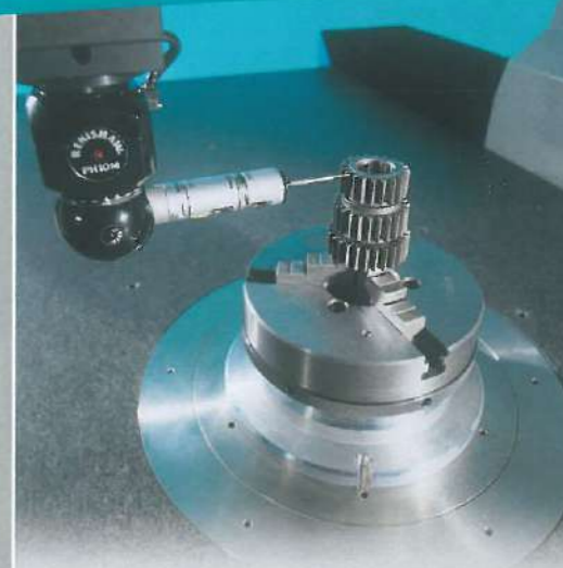
Drehtisch Luftgelagert, wahlweise eben in die Basisplatte eingebaut.
