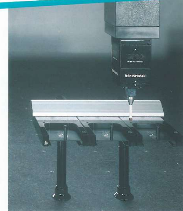
Wechselsystem SCP 80 Speichermodul zum automatischen Wechseln von SH80 Tastereinsatzhaltern des SP80.
