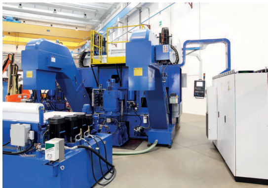
La parte posteriore della macchina con, in primo piano, il sistema filtrante e gli evacuatori di trucioli
