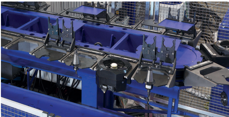
Il magazzino può accogliere sia utensili, sia teste e accessori
