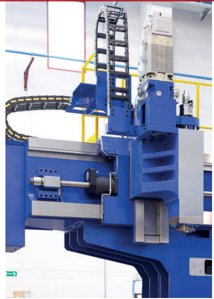
Testa di lavoro con mandrino di foratura/fresatura integrato per la macchina nella versione con magazzini utensili
