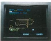
Bei der Programmierung von CNC-gesteuerten Maschinen ist es besonders wichtig, schnell und komfortabel ein Programm erstellen zu können. Diese Anforderungen werden an der MAHO-GRAZIANO 432 T durch eine menügeführte Dialogprogrammierung mit graphischer Unterstützung gelöst.
