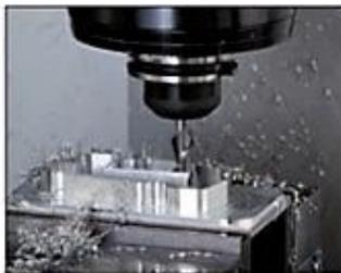
Die Mini Mill und Super Mini Mill sind ideal zur Bearbeitung kleiner Teile, wie sie in der Werkstattfertigung häufig vorkommen. Die 40er-Steilkegelspindel ist perfekt für die Fertigbearbeitung und das Fräsen von Aluminium.
