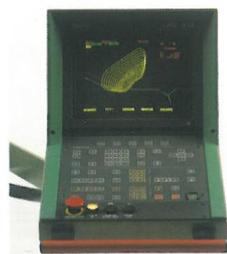
Jeder Arbeitsgang einer CNC-Werkzeugmaschine wird von einem Computer gesteuert, genauer, von einer Mikroprozessor-Bahnsteuerung von 3 bis 5 Achsen.
