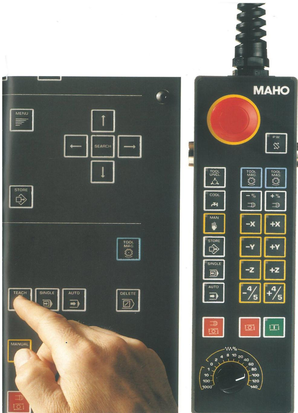
leistungsfähige Geometrie-Rechensystem der MAHO CNC 432 macht das Programmieren einfacher und schneller. Eine große Hilfe dabei sind die Zyklen, feste Programme, denen man nur noch die verlangten Maße eingeben muß, sowie parametrisierbare Unterprogramme.
