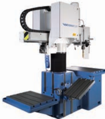
Winkeltisch P. 2.30 auf der Maschinen- rückseite mit Schwenktisch P. 2.40 seitlich
