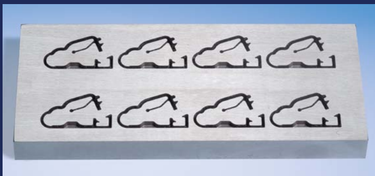
Mehrnest-Bearbeitung mit 8 Kavitäten
